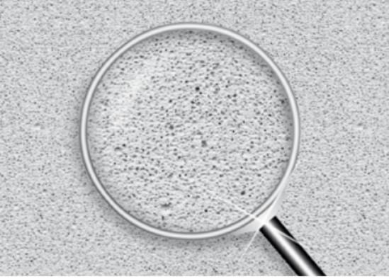
Bei einer Rohdichte von ca. 115 kg/m<sup>3</sup> sorgen Luftporen innerhalb eines Feststoffskeletts, das dem natürlichen Mineral Tobermorit entspricht, für Wärmedämmung
