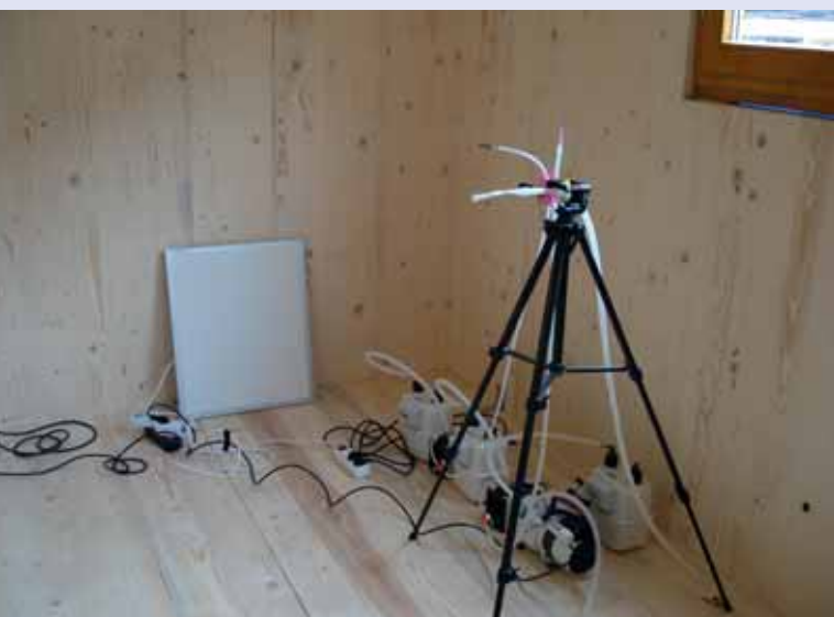
Messstudie: Schadstoffmessung in der Klimabox
