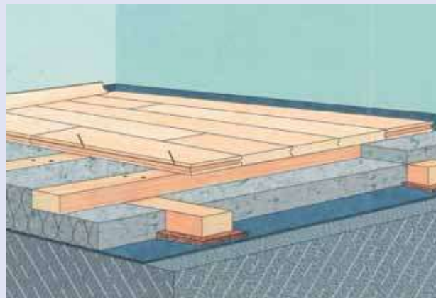
Holzfußboden über Kellerdecke
