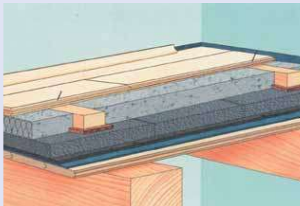
Holzfußboden über sichtbarer Holz-Balkendecke
